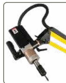
Cabezal universal de posicionamiento rápido
