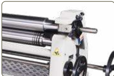
⤴ Desbloqueo manual estandar con sensor de seguridad
