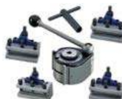
Torreta de cambio rápido montada de serie
