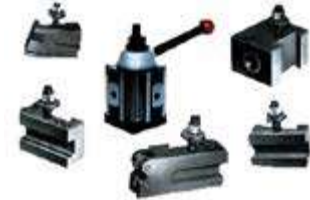
FTX 1000x360 TO DCR Torreta de cambio rápido montada de serie
