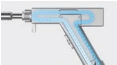
Diseño de circuito de agua circulante · Enfriamiento rápido del cuerpo de la pistola.
